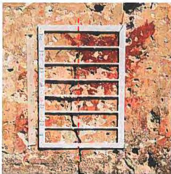
Foto 30: Zona de prueba con la plantilla de los productos analizados como consolidantes, fijativos y de capa de intervención
