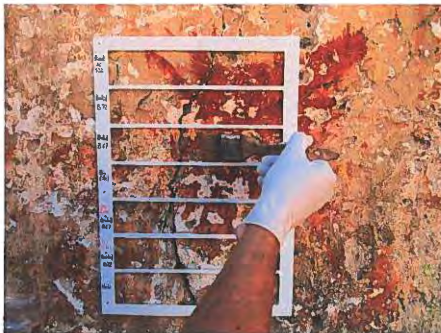
Foto 26: Aplicación de diversos productos en franjas para evaluar los resultados tras su engasado y arranque
