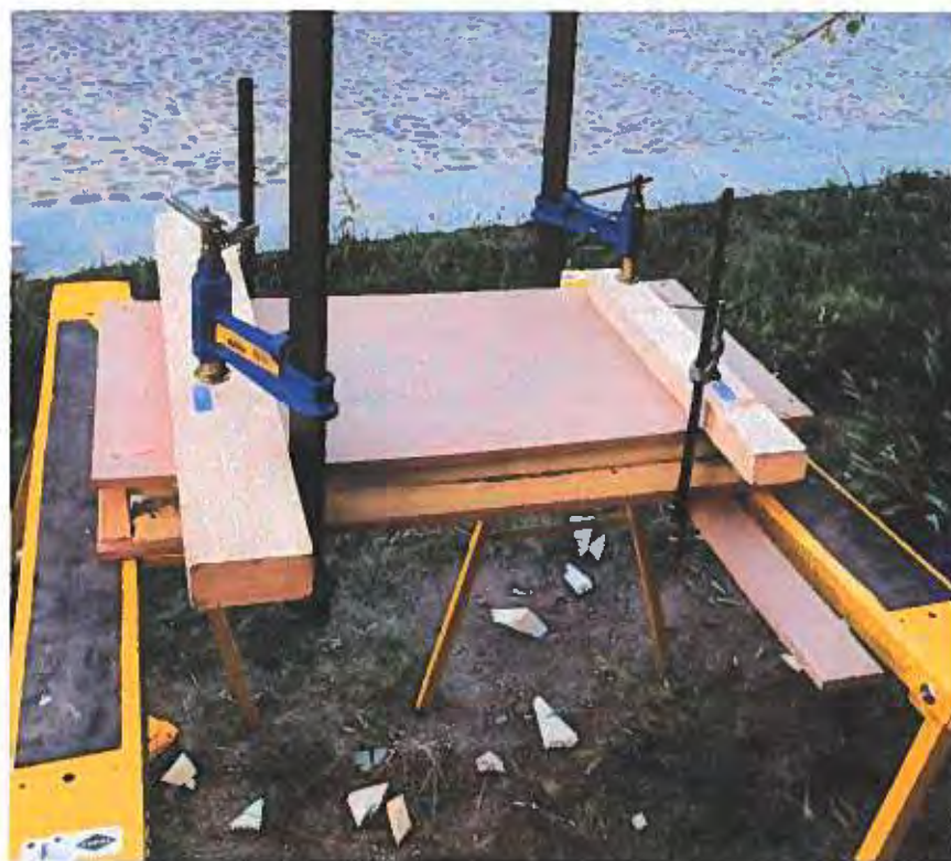
Foto 55: Construcción de soportes a medida de cada pieza para su traslado y almacenaje
