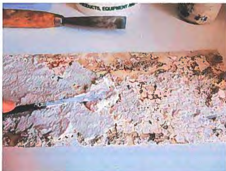
Foto 38: Pruebas con el mortero de restauración PLM-S
