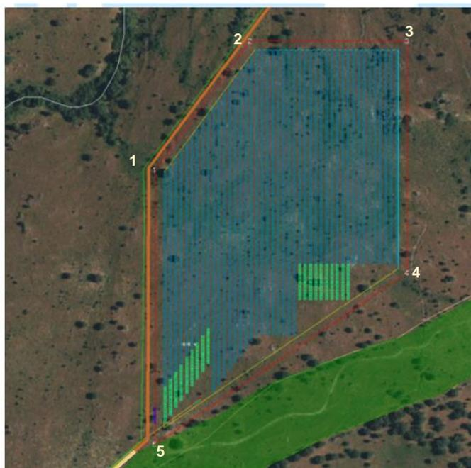
Fig. Plano de coordenadas de replanteo del vallado de la planta solar (Fuente: Proyecto básico de la planta solar)
