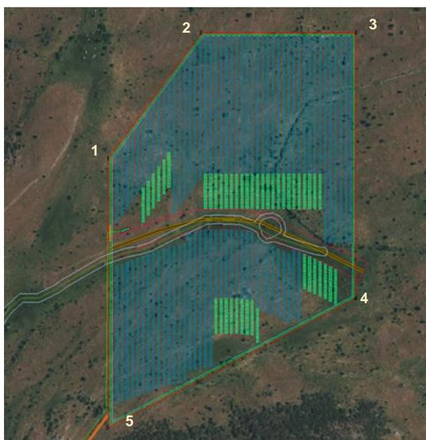
Fig. Plano de coordenadas de replanteo del vallado de la planta solar (Fuente: Proyecto básico de la planta solar)
